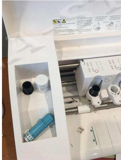
Le CAMEO 4 n'a qu'un seul emplacement pour stocker une seule lame du côté gauche de la machine.
